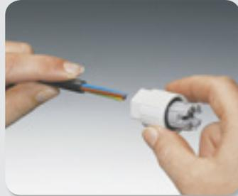
Adern in die gekennzeichneten Aderführungen einrasten und überstehende Aderenden bündig (ohne Überstand) abschneiden.
